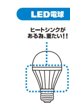
LED電球は放熱対策(ヒートシンク)を必ず搭載しています。その為、電球の重量も増し、熱くなります。ソラナ電球はヒートシンクの搭載が必要なく安価で製作可能です。
