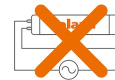
お使いの蛍光灯に印字されている型式をご確認の上、A~Cのいずれかの配線替え工事を行ってください。工事が完了したら、同封の「電源直結工事済」シールを灯具の見える所に貼ってください。
