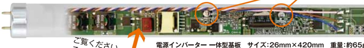
電源インバーター一体型基板 サイズ:26mm×420mm 重量:約65g
